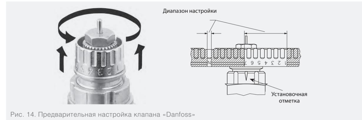
Рис. 14. Предварительная настройка клапана «Danfoss»
