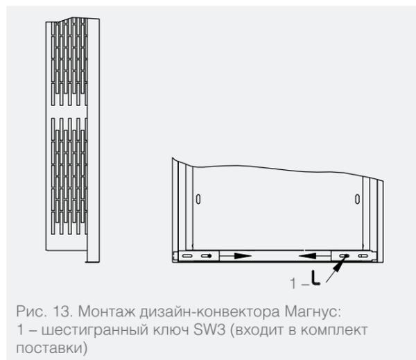
Рис. 13. Монтаж дизайн-конвектора Магнус: 1 – шестигранный ключ SW3 (входит в комплект поставки)
