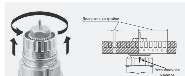
Рис. 11. Предварительная настройка клапана Danfoss
